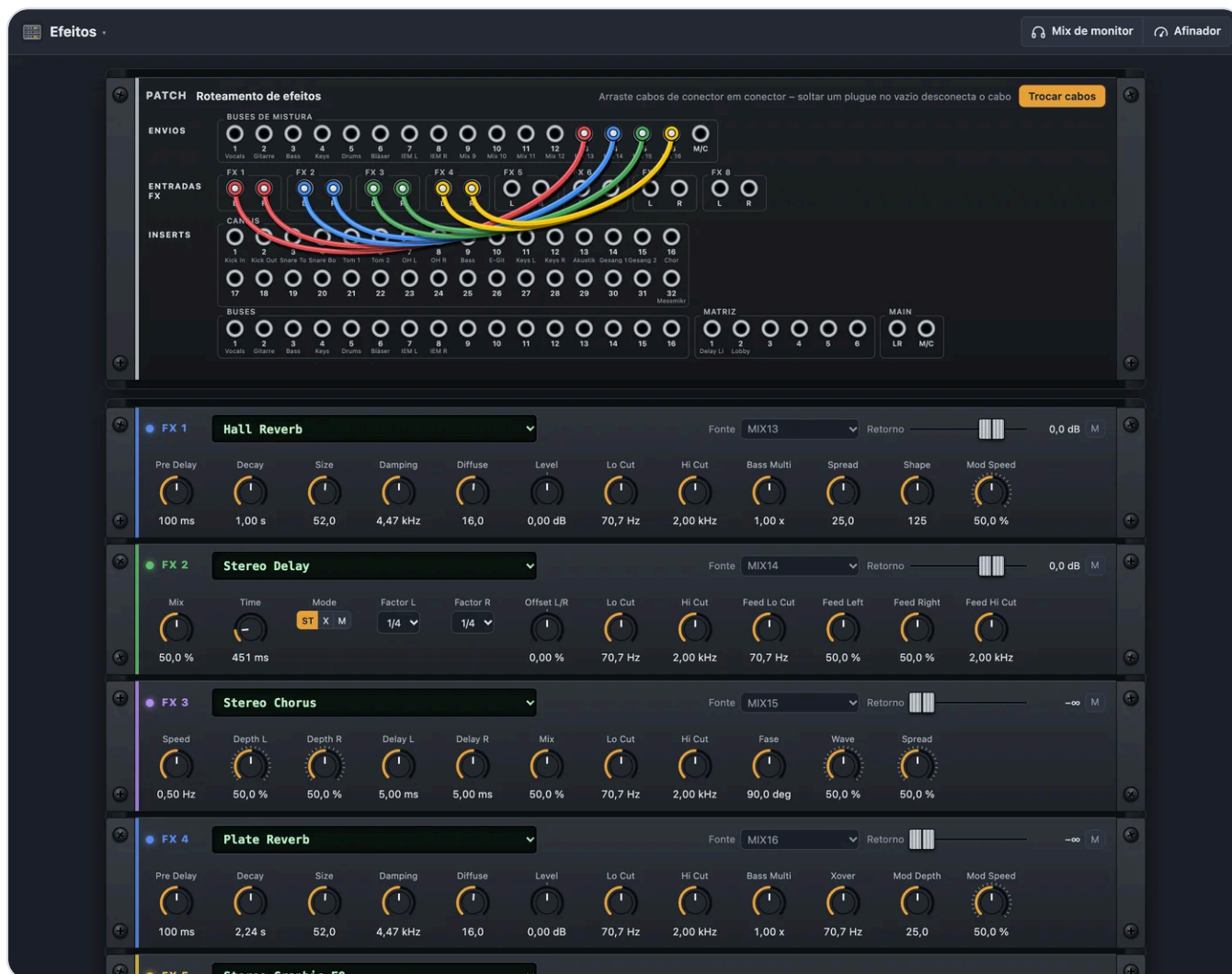
O patch bay com “Trocar cabos”
